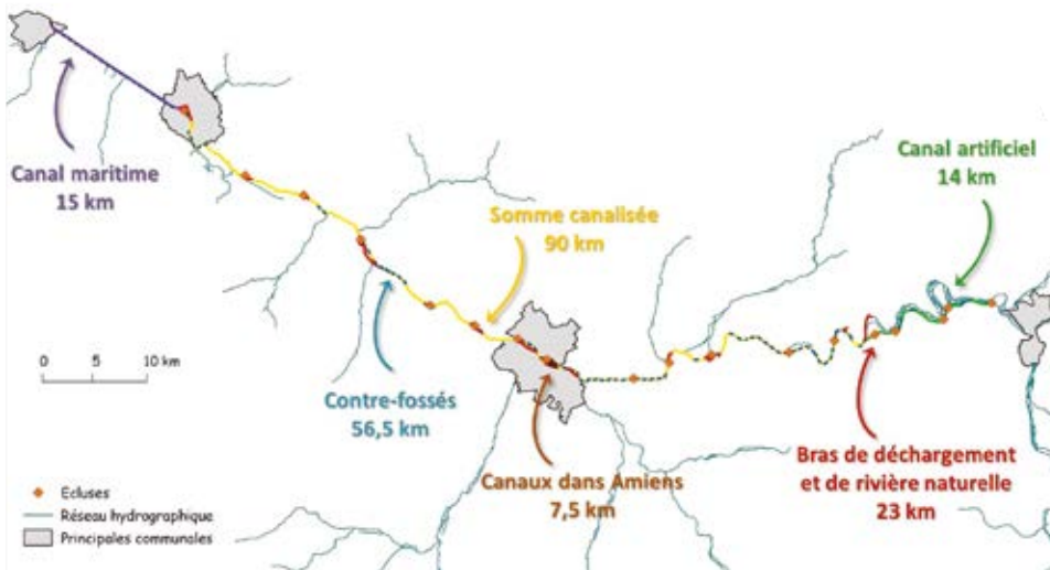
Figure 36 : Schéma des différentes « portions » du fleuve Somme selon les travaux de canalisation (PDG Fleuve Somme - AMEVA 2013).
