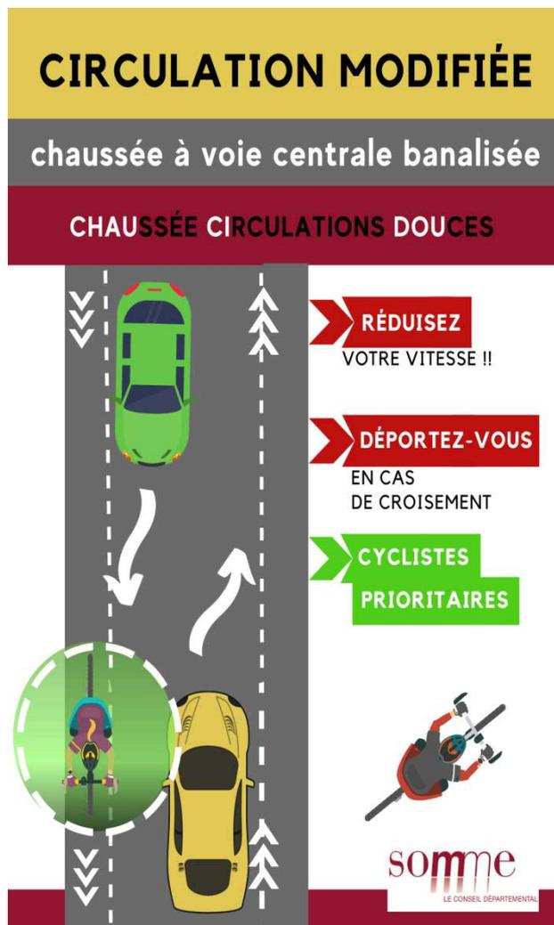
*Schéma explicatif du fonctionnement d'un chaudiou*
