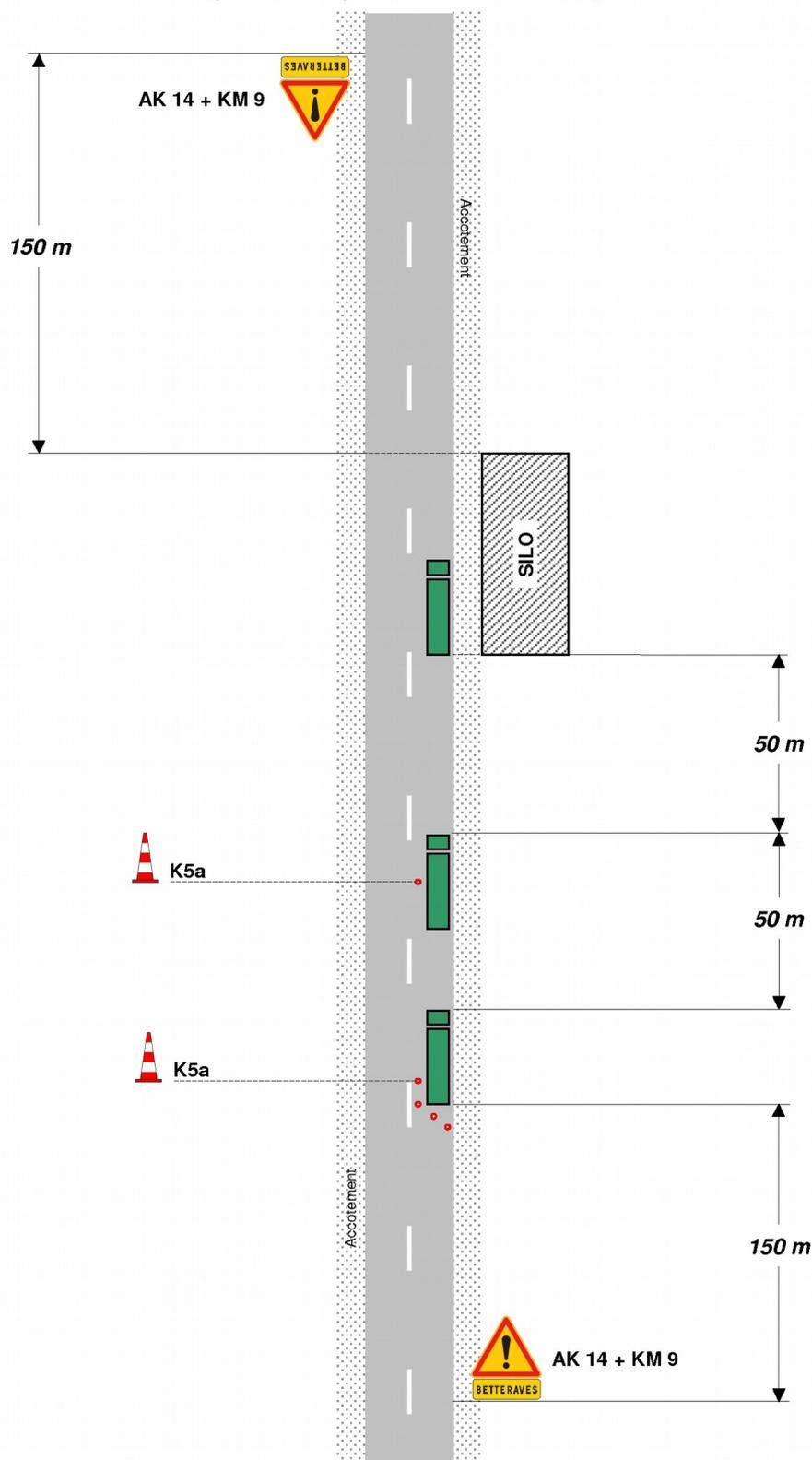
Les signaux de danger AK14 peuvent être utilisés sans feux clignotants R2, s'ils sont équipés d'un revêtement rétro-réfléchissant de classe 2.
