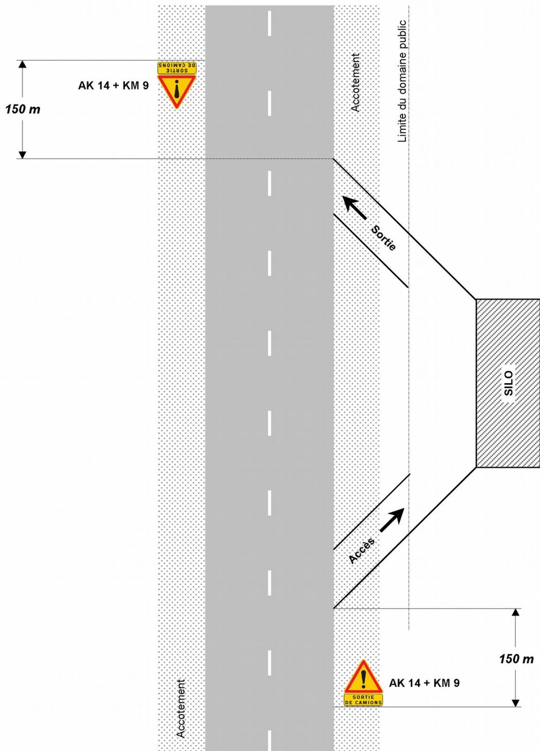
Les signaux de danger AK14 peuvent être utilisés sans feux clignotants R2, s'ils sont équipés d'un revêtement rétro-réfléchissant de classe 2.
