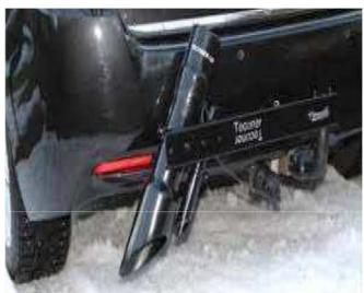
Dès 2019, le Département s'est équipé de "**teconer**". Ces appareils embarqués utilisent une technologie de pointe qui permet aux agents patrouilleurs de surveiller les routes : humidité, température de chaussée, glissance, ...
