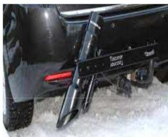
En 2019, le Département s'est équipé de **"teconer"**. Ces appareils embarqués utilisent une technologie de pointe qui permet aux agents patrouilleurs de surveiller les routes et de mesurer avec précision et régularité l'état des routes.
